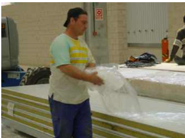
1.-RETIRADA DE FILM CARA EXTERIOR
